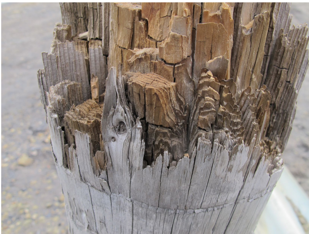
Innvendige råteskader i tømmer med jordkontakt på Svalbard. Internal fungal deterioration in wooden pole with soil contact at Svalbard. Photo: Mycoteam.
